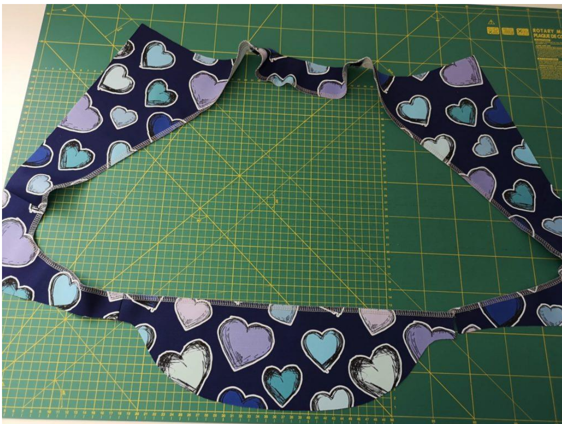
33. Vnitřní část podsádek v jednom kroku začistíme overlockem.
